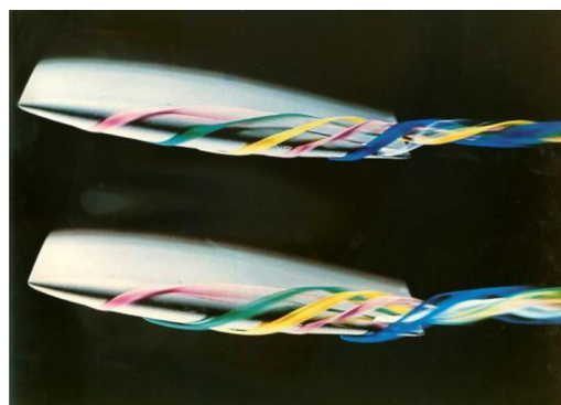
Obr. 5.3 Vizualizácia vírov na konci krídla v hydrodynamickom tuneli pomocou vstrekovania farbiva; Werlé, 1974 [2]
