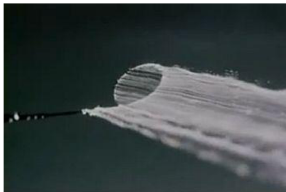
Obr. 8.1 Vznik vodíkových bubliniek na katóde [12]
