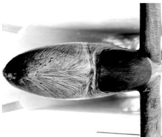
Obr. 6.1 Vizualizácia prúdenia v blízkosti povrchu pomocou olejového náteru v oblasti prechodu trupu a krídla klzáku [20]
