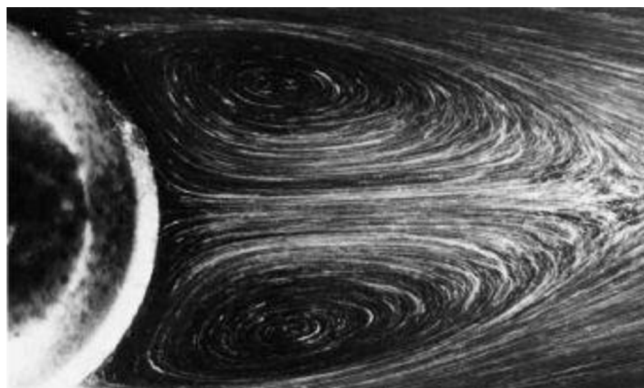
Obr. 5.12 Vizualizácia úplavu na hladine za obtekaným sférickým telesom; hliníkový prášok na vodnej hladine [32]
