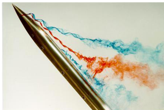
Obr. 5.1 Vizualizácia streaklines pomocou farbiva vo vode [29]
