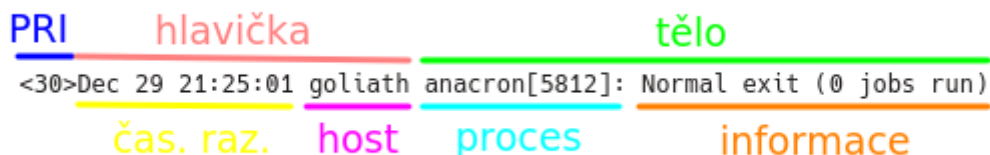
Obrázek 2.8: Syslog zpráva ve formátu RFC3164. Zdroj: vlastní
