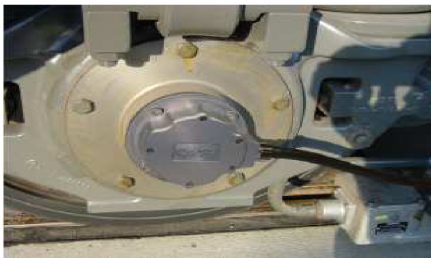
Obrázek 4.1: Ukázka montáže snímače GEL 2710.xx [33]
