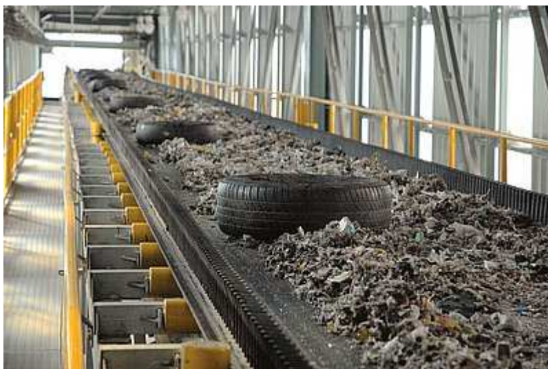
Obr. 16 Dopravní pás s alternativním palivem cementárnách
