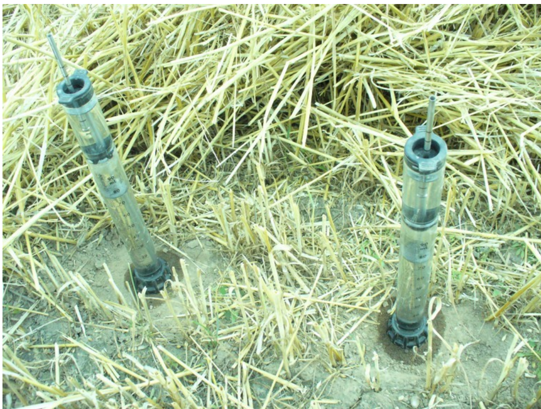
Obrázek 10: Měření infiltrace po sklizni
