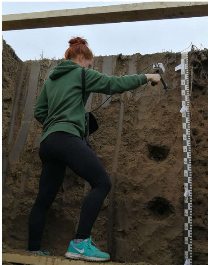
Obr. 4.5 Průběh měření magnetické susceptibility v Brumovicích (zdroj: vlastní)
