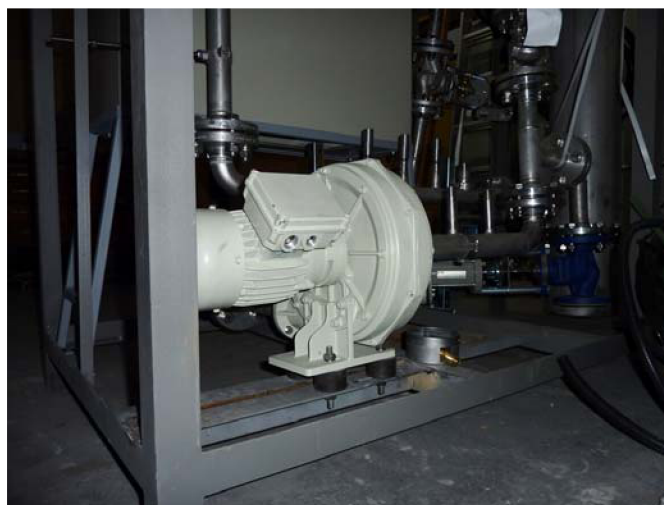
Obr 5.6 Ventilátor s elektromotorem
