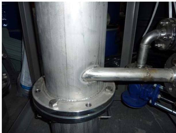
Obr 5.4 Tangenciální vstup do filtrační komory
