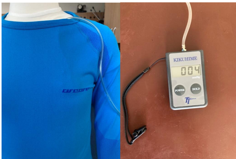
Obr. 25 Měření tlaku na oděvu na figuríně.
