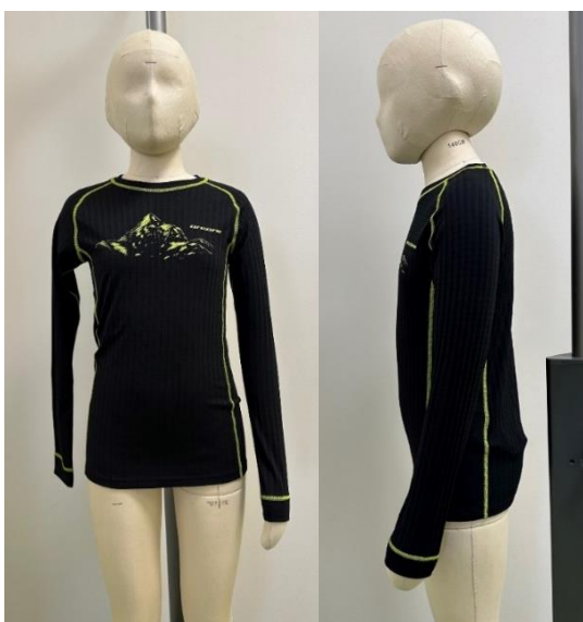
Obr. 23 Ověření padnutí oděvu na standardizované figuríně.
