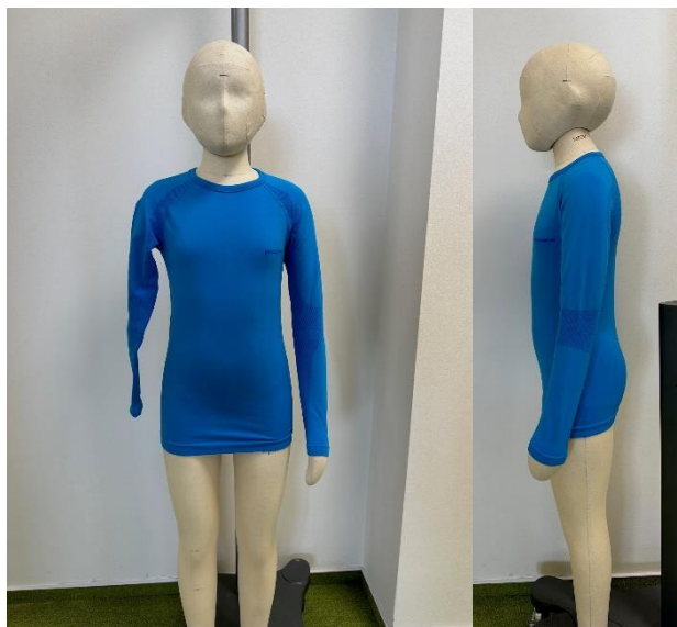
Obr. 22 Ověření padnutí oděvu na standardizované figuríně.
