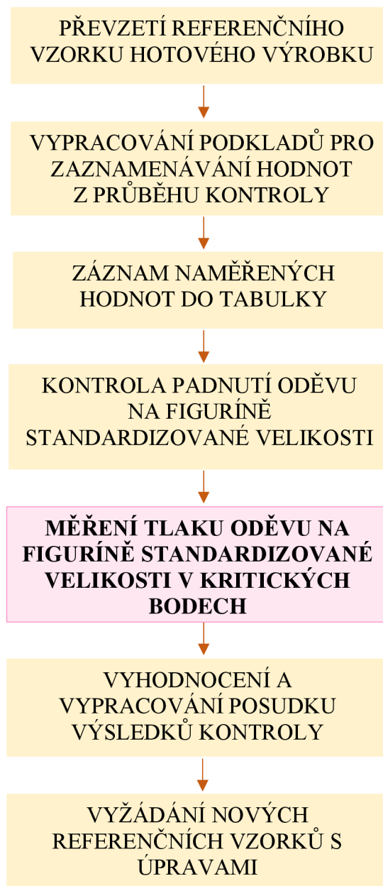
Obr. 26 Diagram pracovního procesu kontroly rozměrů hotových výrobků s inovací.
