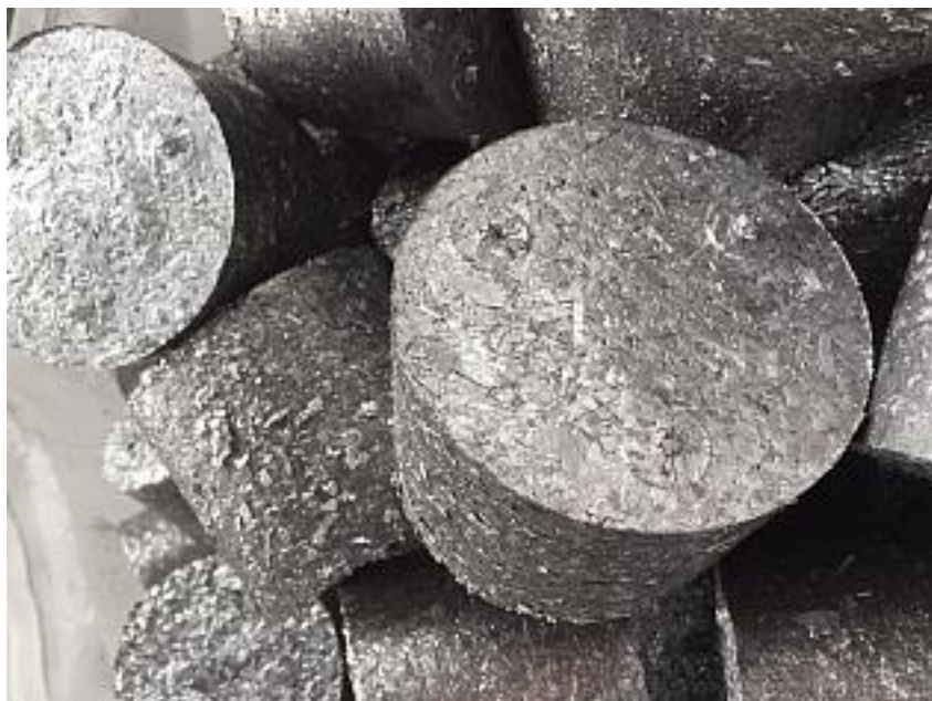
Obrázek č. 3: Vylisované hliníkové brikety (vlastní foto).
