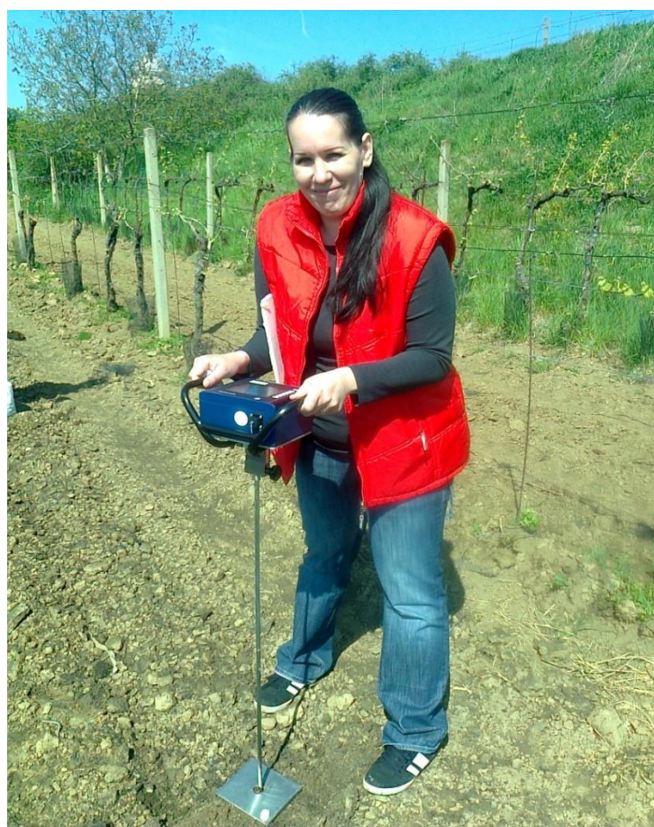
Měření penetrometrického odporu
