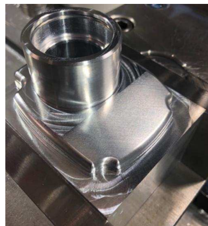
Obr. 33 Výsledek po dokončování řádkováním
