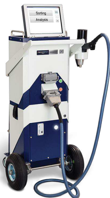
Obr. 17 Opticko-emisní spektrometr PMI-Master Pro2 [13]
