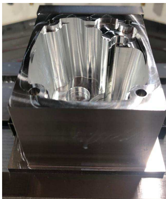
Obr. 35 Výsledek po vrtání
