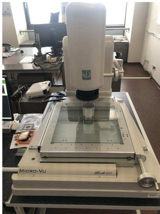
Obr. 63 Měření skříně na stroji Micro-Vu Sol 311
