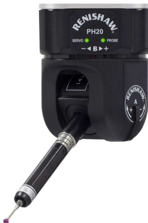
Obr. 67 Snímací systém PH20 [42]
