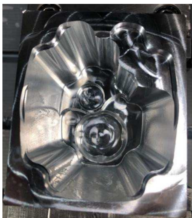
Obr. 32 Výsledek po dokončování optimalizovanou hladinou Z
