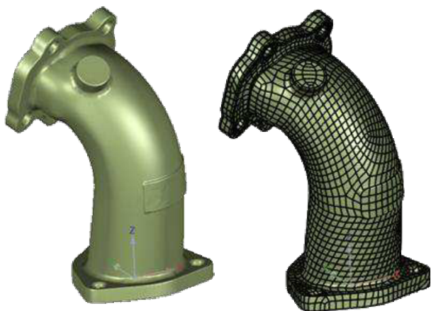
Obr. 18 Zpracování dat z 3D scanneru pomocí automatického generování ploch
