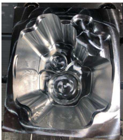
Obr. 32 Výsledek po dokončování optimalizovanou hladinou Z
