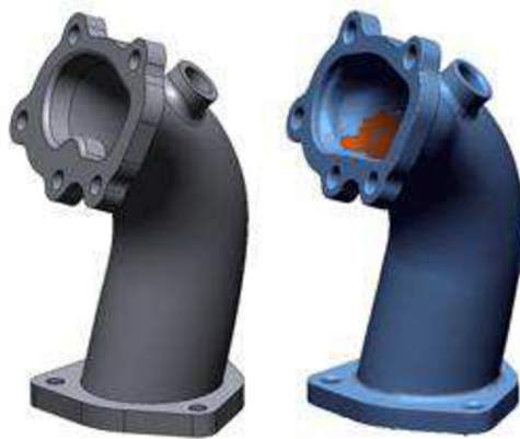
Obr. 19 Zpracování dat z 3D scanneru pomocí klasického modelování formou šablony
