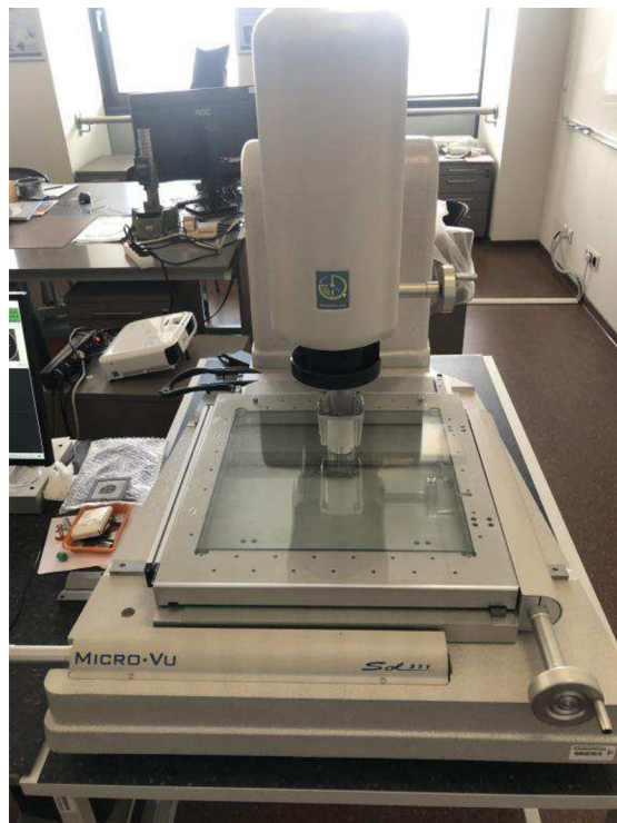
Obr. 63 Měření skříně na stroji Micro-Vu Sol 311
