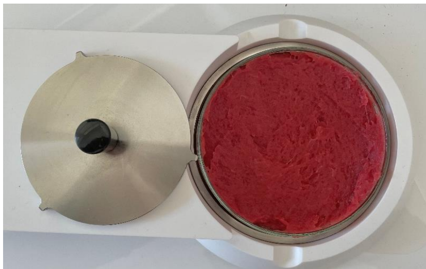
Obrázek 3.5: Homogenát na Petriho misce v přístroji NIRMaste (foto vlastní)
