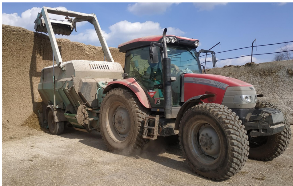
Obrázek č. 10 – Traktor McCormic s míchacím krmným vozem Labrador
