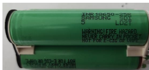
Obr.6.: články INR18650-R25 obsažené v BPA 10825
