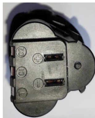
Obr. 4.: pohled na kontakty modulu
