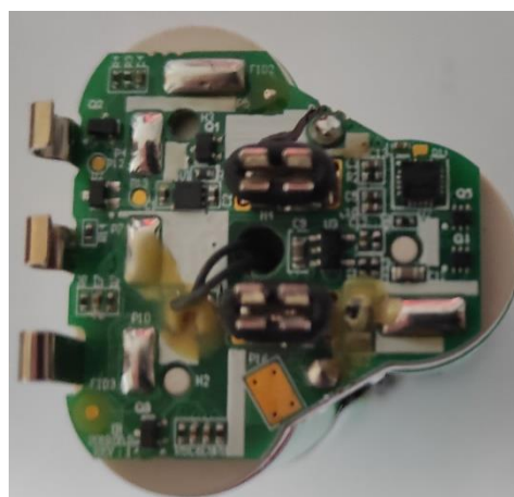
Obr. 8.: deska modulu BPA 10825
