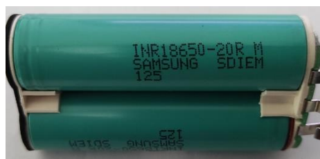
Obr.5.: články INR18650-R20 obsažené v BPA 10820
