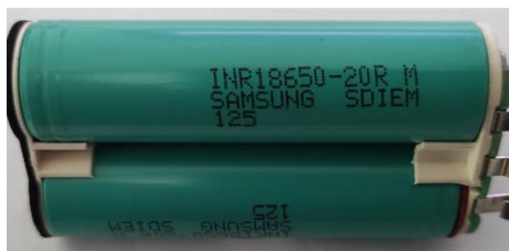
Obr.5.: články INR18650-R20 obsažené v BPA 10820
