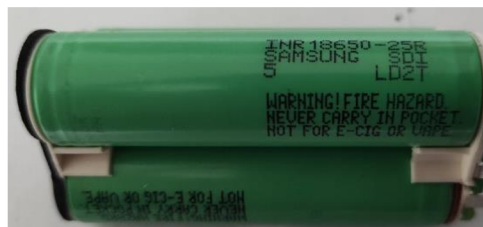
Obr.6.: články INR18650-R25 obsažené v BPA 10825
