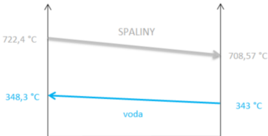
Obrázek 21 Teplotní spády ve spodní části 3. tahu
