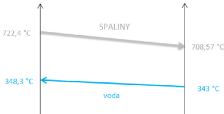
Obrázek 21 Teplotní spády ve spodní části 3. tahu
