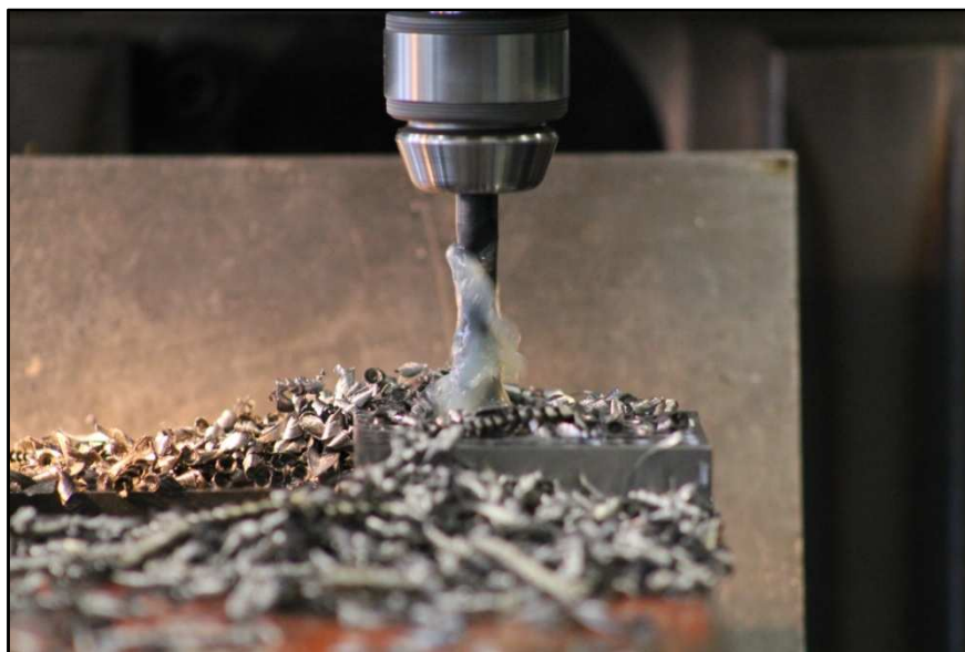
Obr. 31 Zkouška opotřebení břitu řezného nástroje, vrtání s využitím procesní kapaliny.
