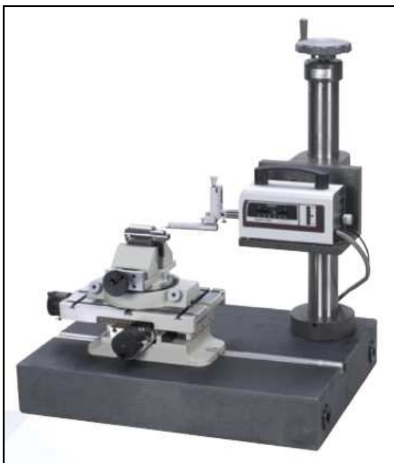
Obr 26: Profiloměr Mitutoyo SurfTest SV-2000N2 a dotek s diamantovou kuželovou špičkou
