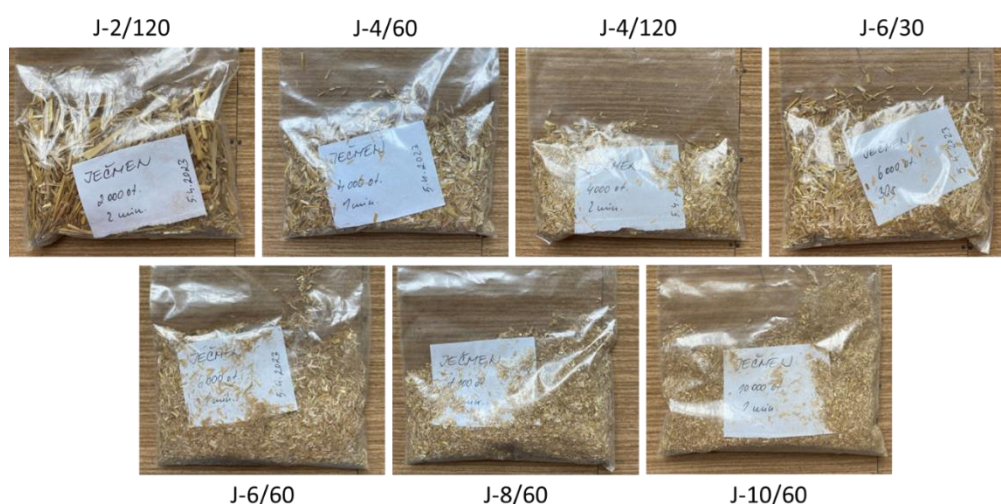
Obrázek 11: Vzorky ječmenné slámy po mechanickém rozvláknění
