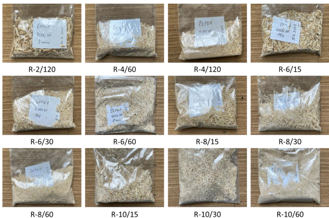
Obrázek 13: Vzorky slámy z řepky olejné po mechanickém rozvláknění
