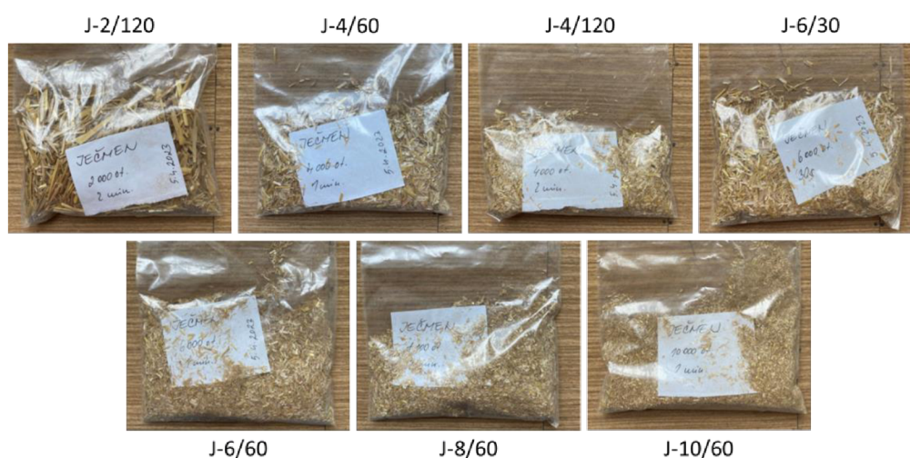
Obrázek 11: Vzorky ječmenné slámy po mechanickém rozvláknění
