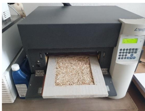
Obrázek 10: Zařízení pro stanovení tepelné vodivosti
