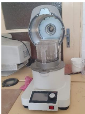
Obrázek 8: Nožový mlýn Pulverisette 11
