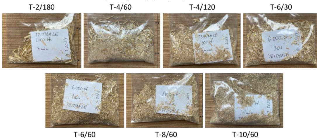
Obrázek 14: Vzorky slámy z triticale po mechanickém rozvláknění
