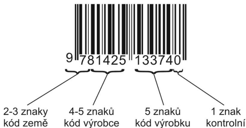
Obr. 5.7 Struktura kódu EAN13
