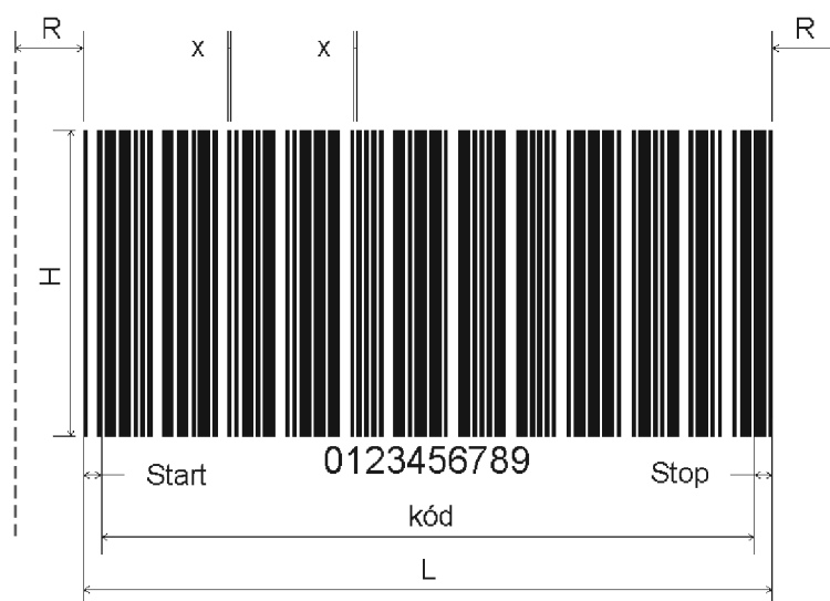
Obr. 3.1 Struktura lineárního čárového kódu
