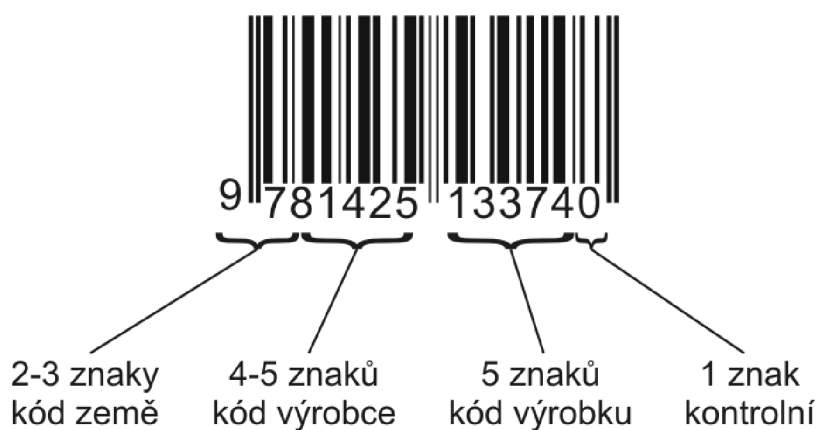
Obr. 5.7 Struktura kódu EAN13
