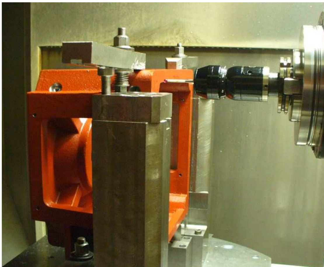
Obr. 5.10 Měření přídavku sondou MP9.
