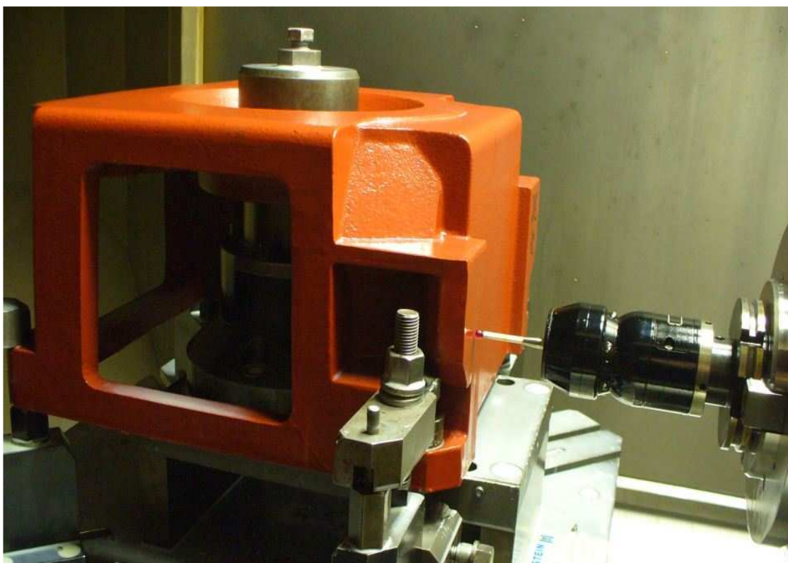
Obr. 5.9 Zjištění polohy obrobku sondou MP9.
