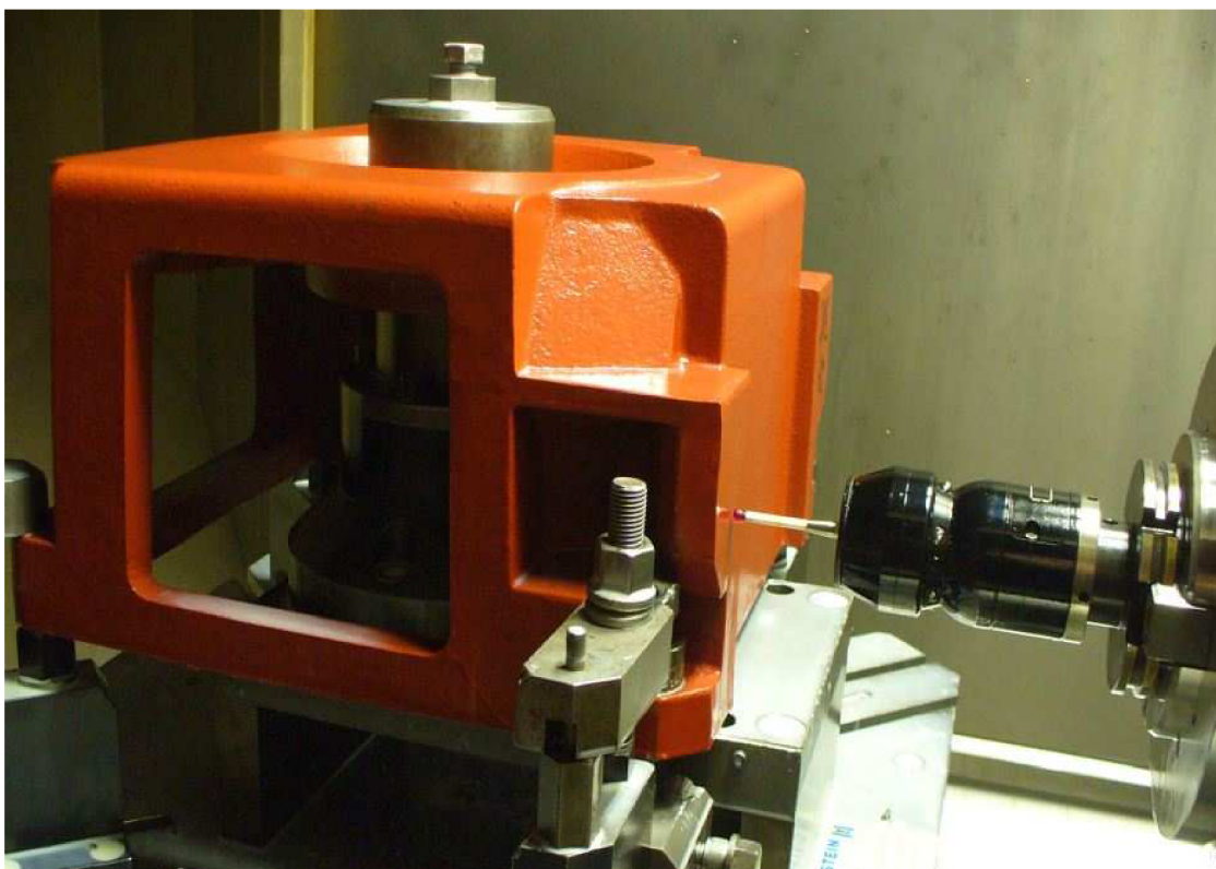
Obr. 5.9 Zjištění polohy obrobku sondou MP9.
