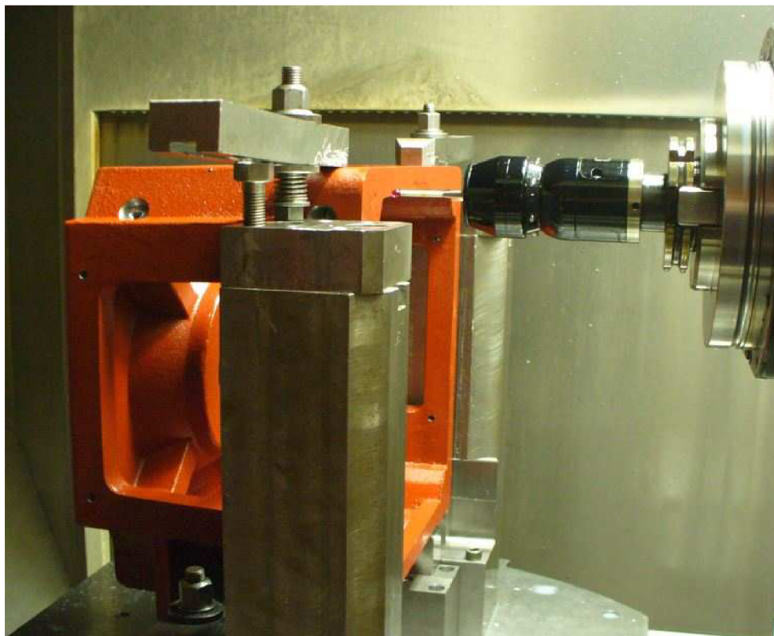
Obr. 5.10 Měření přídavku sondou MP9.
