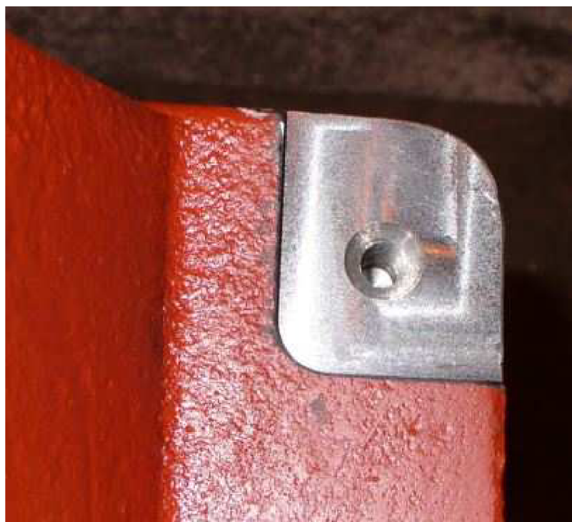
Obr. 7.2 Plocha pro zemnicí kabel.
