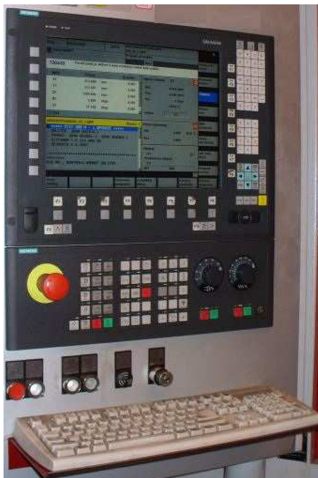
Obr. 7.2 Obslužný panel OP010C s přidavnou klávesnicí.
