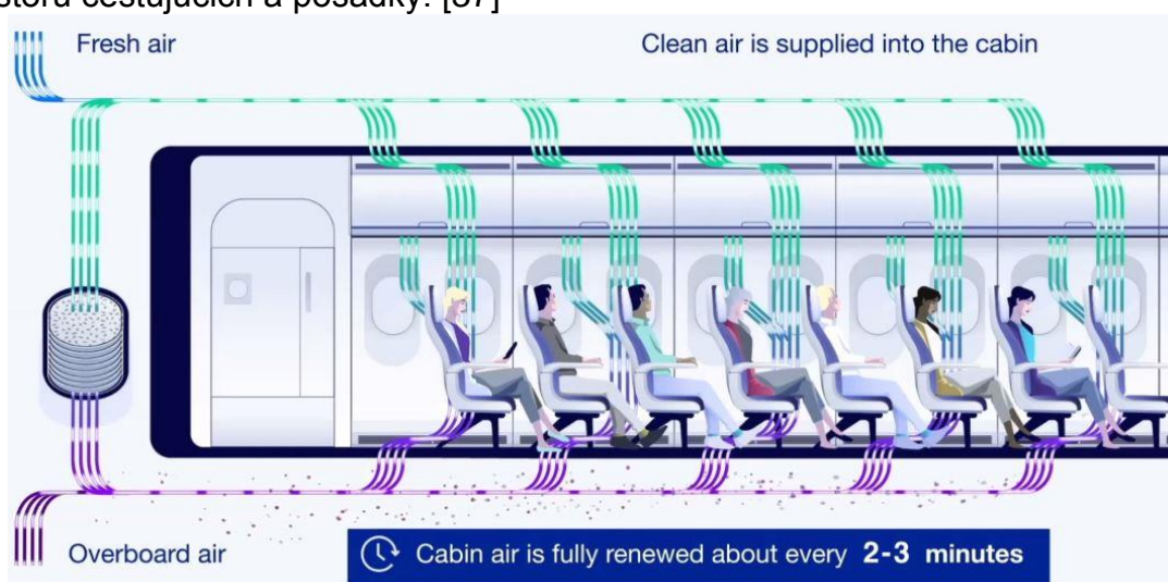
Obr. 3.22 Výmena vzduchu v kabíne [37]
