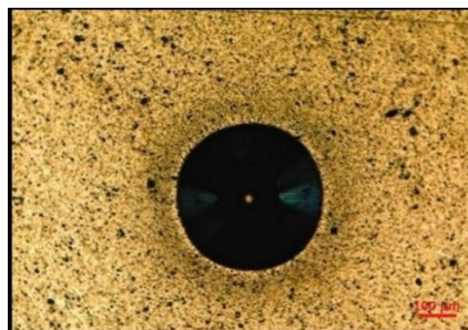
Obr. 21 Zobrazení vtisku po měření indentační zkouškou. 41
