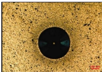
Obr. 21 Zobrazení vtisku po měření indentační zkouškou. 41
