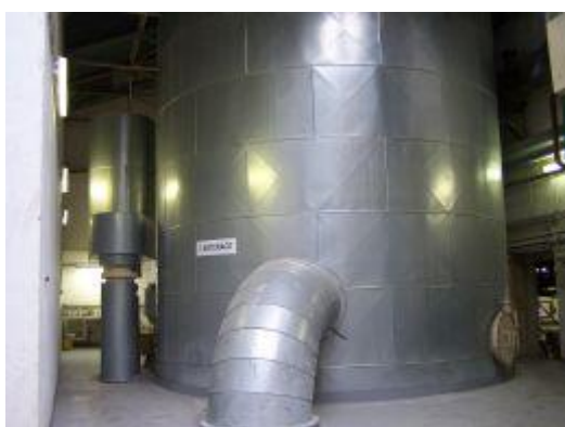
Obr. 24 – Saturák I. saturace (Dobrovice) [29]
