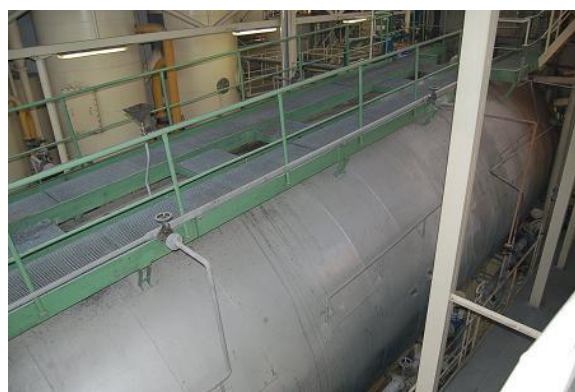
Obr. 19 – Žlabová difuze DdS (Vrbátka) [33]
