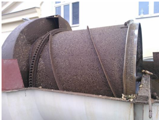
Obr. 45 – Lapač kamenů a písku Sokolov (Litovel) [47]
