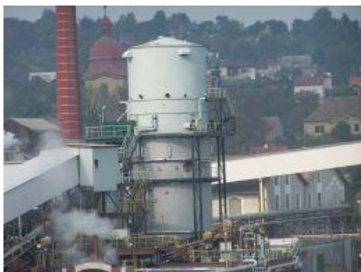
Obr. 18 – Věžová difuze BMA (Dobruška) [29]
