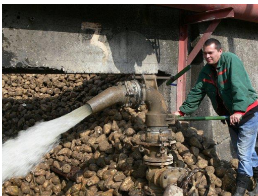
Obr. 8 – Vodní dělo – střík Fölsche (Prosenice) [31]
