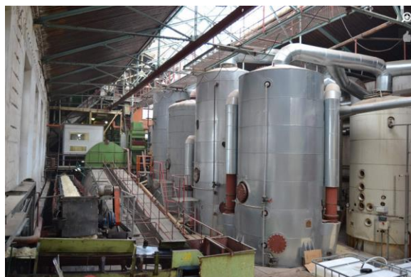
Obr. 33 – Pětičlenná odparka (Prosenice) [32]
