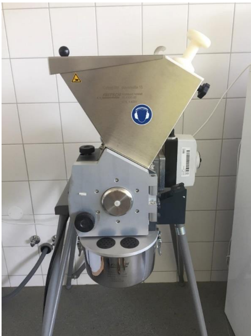
Obr. 19: Příklad přístroje FRITSCH-Pulverisette; používaný v laboratořích FŽP k homogenizování pevných vzorků (Zdroj: vlastní)
