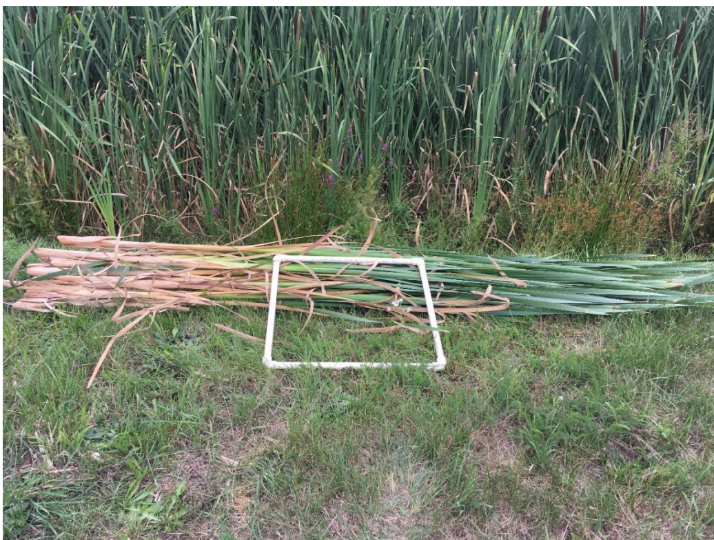
Obr. 17: Odebírání vzorků biomasy pomocí čtverce o rozměrech 0,5 m x 0,5 m.
