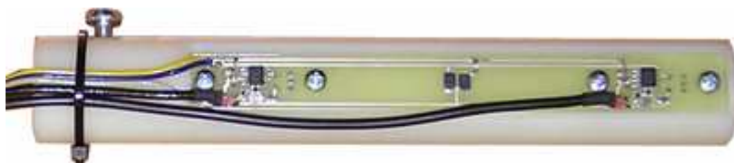
Obr. 6.15 Fotografie přípravku č. 4, obsahující dvě měřící hradla
