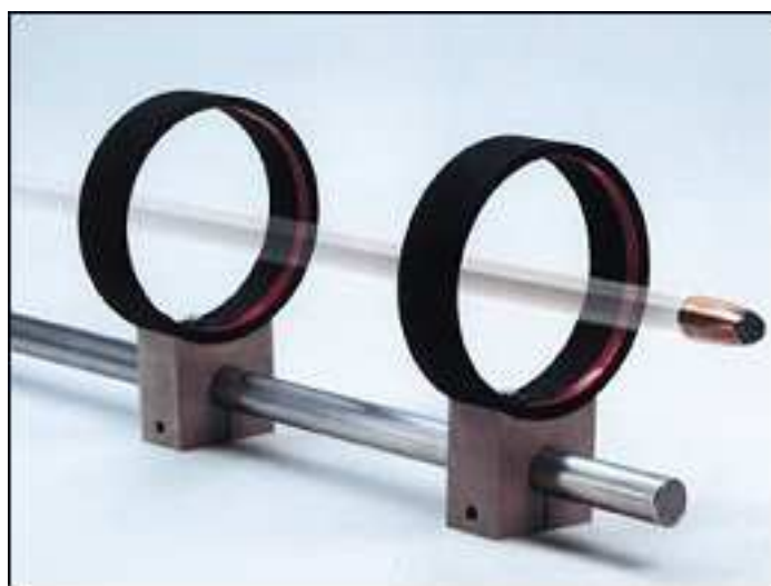
Obr. 6.4 Elektromagnetické hradlo Senzore (viz. [10])
