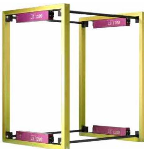
Obr. 6.1 Diodové hradlo Kurzzeitmesstechnik Werner Mehl (viz. [9])
