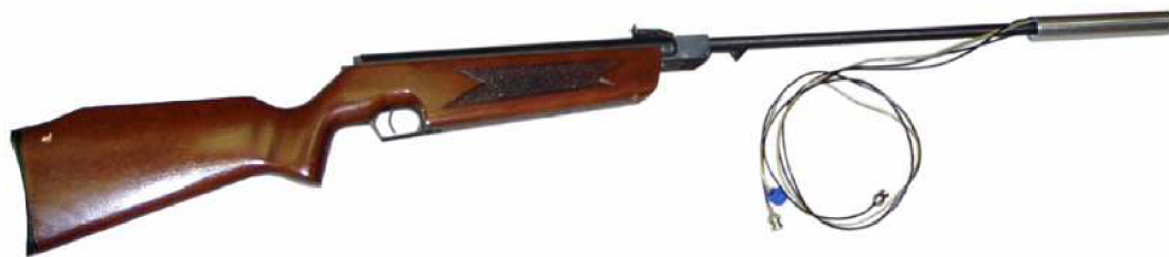
Obr. 6.16 Fotografie přípravku č. 4, nasazeného na hlaveň vzduchové pušky. Celý přípravek je ještě stíněn kovovým krytem, spojeným se zemí.
