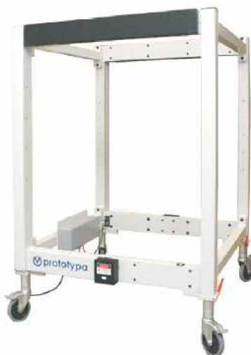
Obr. 6.2 Laserové hradlo PROTOTYPA a.s. (viz. [7])
