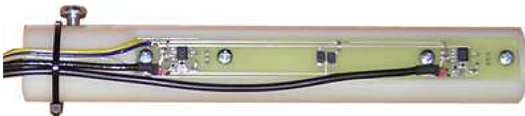
Obr. 6.15 Fotografie přípravku č. 4, obsahující dvě měřící hradla
