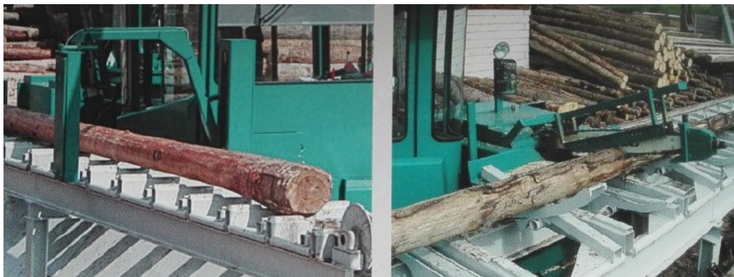
Obr. 21 Měřicí rám a zkracovací pila třídícího vozíku RSTW
