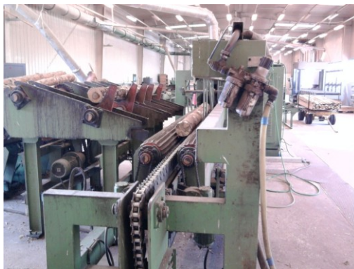
Obr. 9 Pilnice II. – kotoučová pila, hl.stroj
