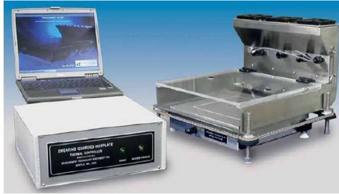
Obr. 6 Prístroj SGHP **code 3123** na meranie tepelného odporu a priepustnosti vodných pár [25]
