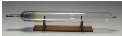
Obr. 12 Jedna z prvých (cca r. 1900) x-ray trubíc o dĺžke 50 cm [28]
