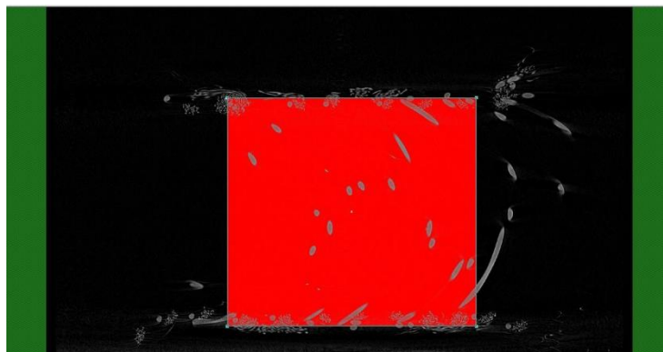
Obr. 37 Výber obdĺžnikového tvaru ROI podľa geometrického tvaru vzorky v CTAn programe v časti „region of interest“
