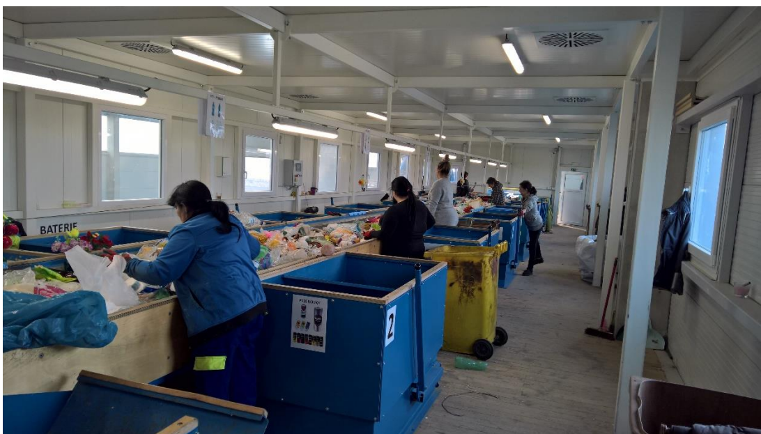
Obrázek 12: Třídící linka – pohled na separační pracoviště
