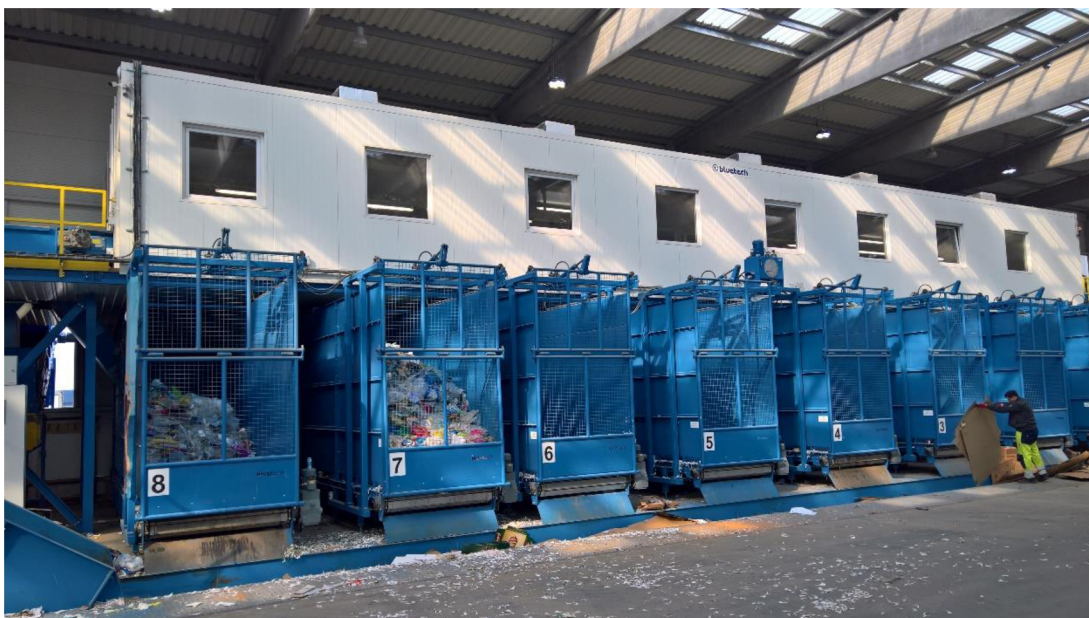
Obrázek 17: Třídící linka – pohled na shromažďovací kontejnery
