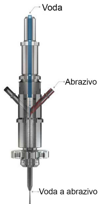
Obr. 5 Schéma abrazivního vodního paprsku firmy Flow [14].
