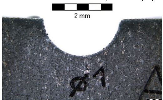
Obr. 45 Porovnání vzorků oceli S235, tl. 10 mm: A) Laser (vlevo), zvětšeno 6,3×. B) Vodní paprsek (vpravo), zvětšeno 6,3×.
