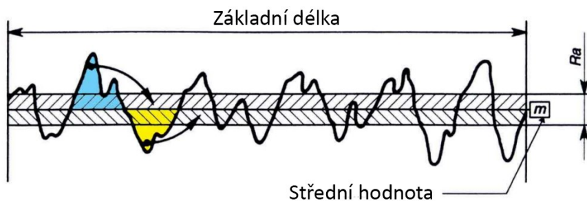
Obr. 54 Metodika hodnocení drsnosti povrchu Ra [44].
