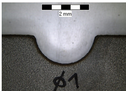
Obr. 43 Porovnání vzorků AISI 304L, tl. 5 mm: A) Laser (vlevo), zvětšeno 6,3×. B) Vodní paprsek (vpravo), zvětšeno 6,3×.
