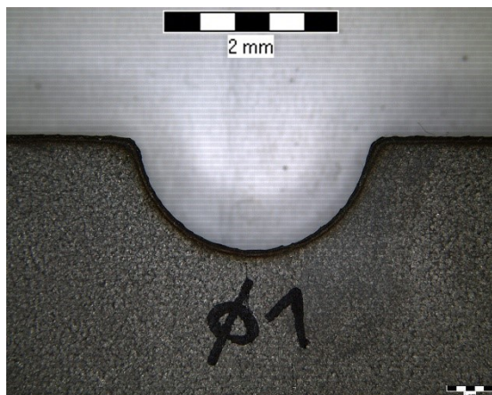
Obr. 40 Pohled na půlkruhové vybrání: A) Označené \varnothing 1 (vlevo), zvětšeno 6,3×. B) Měření zaoblení hran (vpravo), zvětšeno 6,3×.
