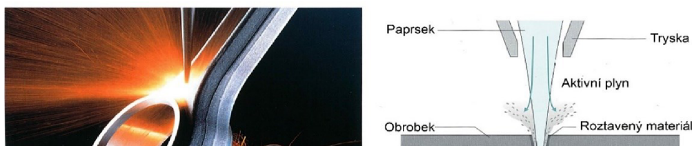
Obr. 24 Vrtání pomocí laserové paprsku [15].
