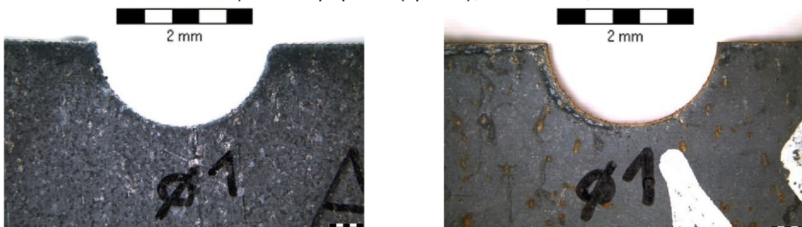
Obr. 45 Porovnání vzorků oceli S235, tl. 10 mm: A) Laser (vlevo), zvětšeno 6,3×. B) Vodní paprsek (vpravo), zvětšeno 6,3×.
