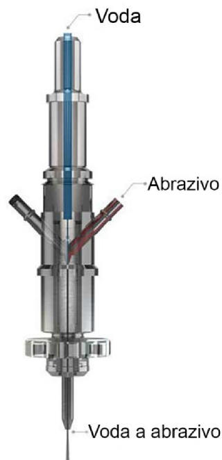
Obr. 5 Schéma abrazivního vodního paprsku firmy Flow [14].
