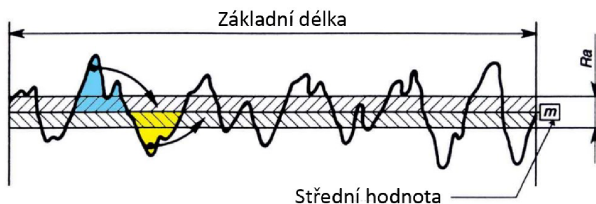
Obr. 54 Metodika hodnocení drsnosti povrchu Ra [44].
