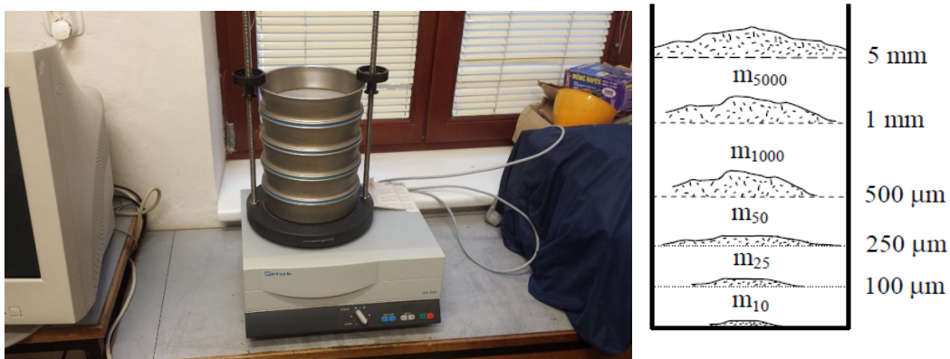
Obr. 24 Retsch AS 200 digit a schéma síťování (Kopecký, 2007)
