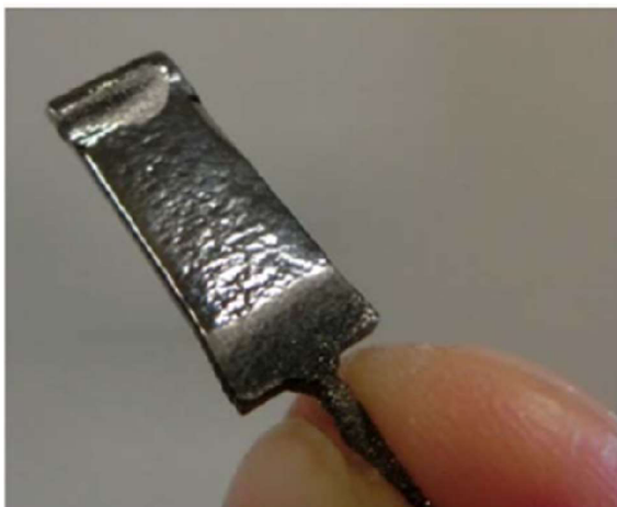
Obr. 4-3 Původně vzorek kvádrového tvaru po 20 minutách elektrolytického leštění [46]
