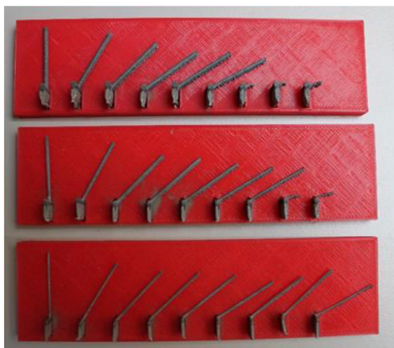
obr. 4-8 Vzorky tištěné s výškou vrstvy 50 \mu\text{m} .
