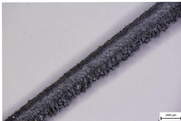
obr. 5-8 Prut s průměrem 1,5 mm a sklonem 40° vyráběný s výškou vrstvy 30 μm.
