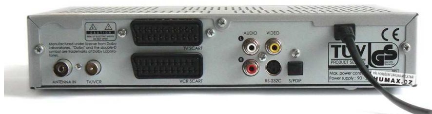
Obr. 3 Pohled na zadní panel opatřený vstupními a výstupními konektory (originální stav)
