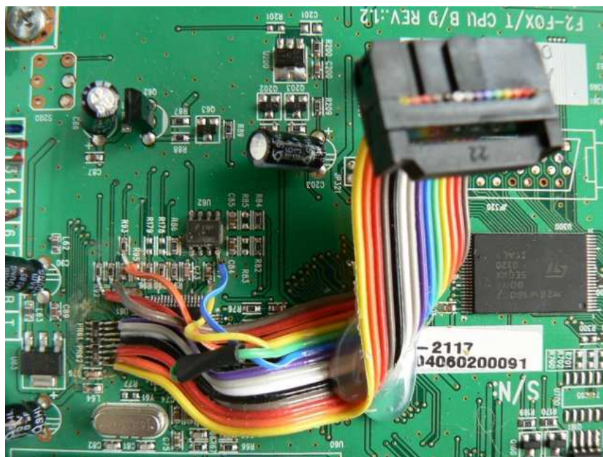
Obr. 45 Pohled na připojení vodičů k COFDM demodulátoru
