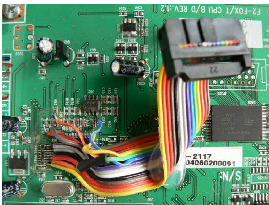
Obr. 45 Pohled na připojení vodičů k COFDM demodulátoru
