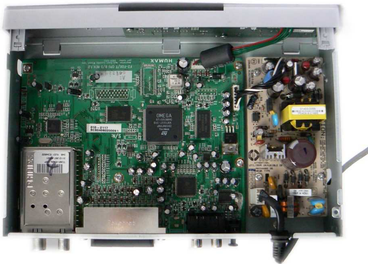
Obr.5 Vnitřní uspořádání přijímače HUMAX F3-FOX T
