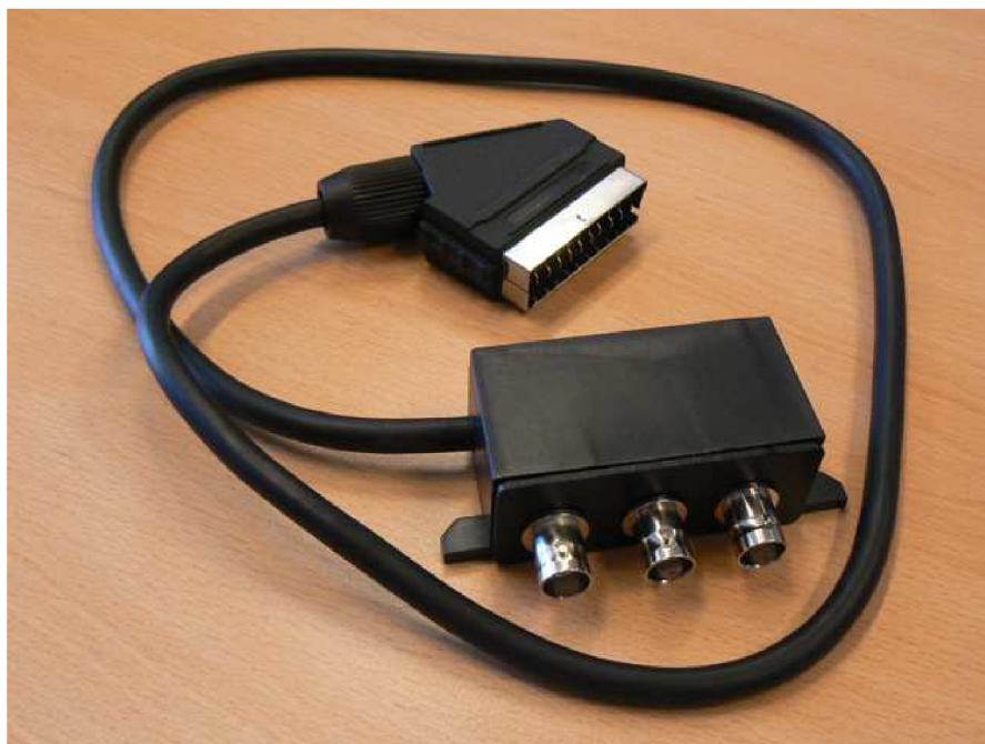
Obr. 52 Redukce SCART – 3x BNC pro RGB signály
