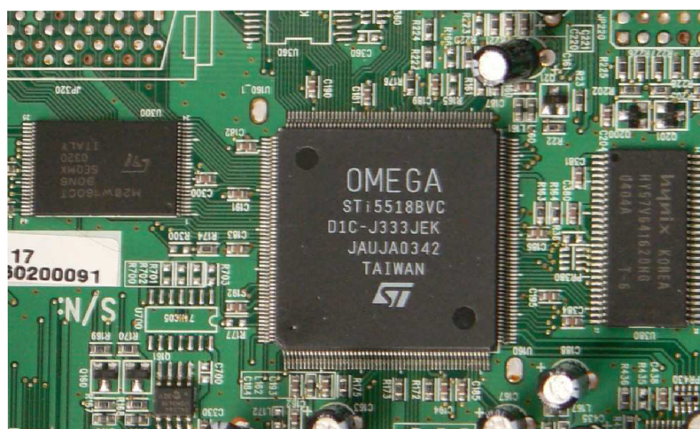
Obr. 12 Pohled na STi5518BVC s flash (vlevo) a RAM pamětí (vpravo)
