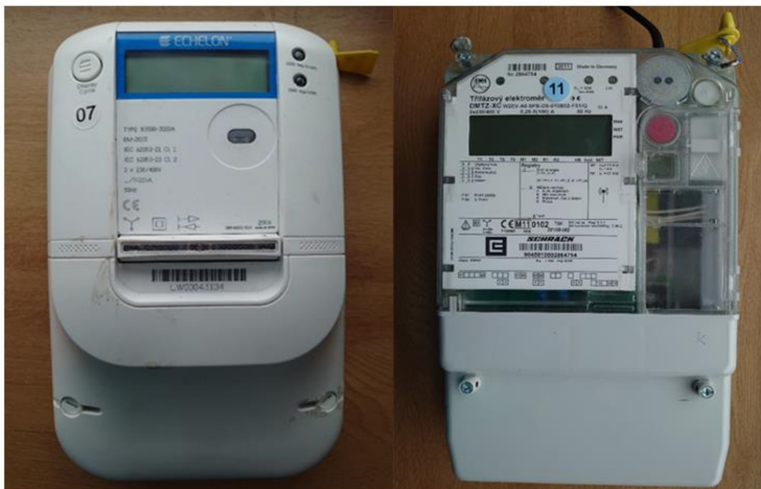
Obr. 6 vlevo Echelon Type 83500, vpravo Schrack DMTZ-XC Zdroj: vlastní zpracování
