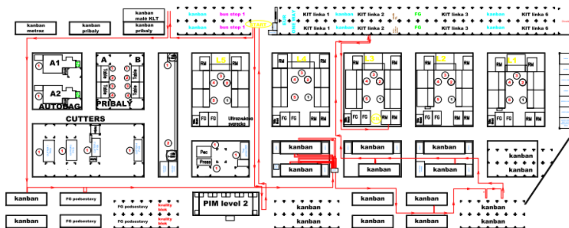
Obr. 3.24 Teoretický pohyb „water – spidera“ během vychystávání materiálu [35,38]
