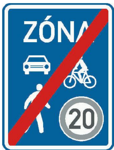
Obr. č. 2- Dopravní značení konec sdílené zóny
