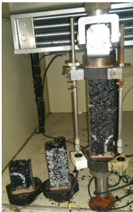
Obr. 16: Vpravo: Upevnění zkušebního tělesa, vlevo: Porušené těleso po zkoušce
