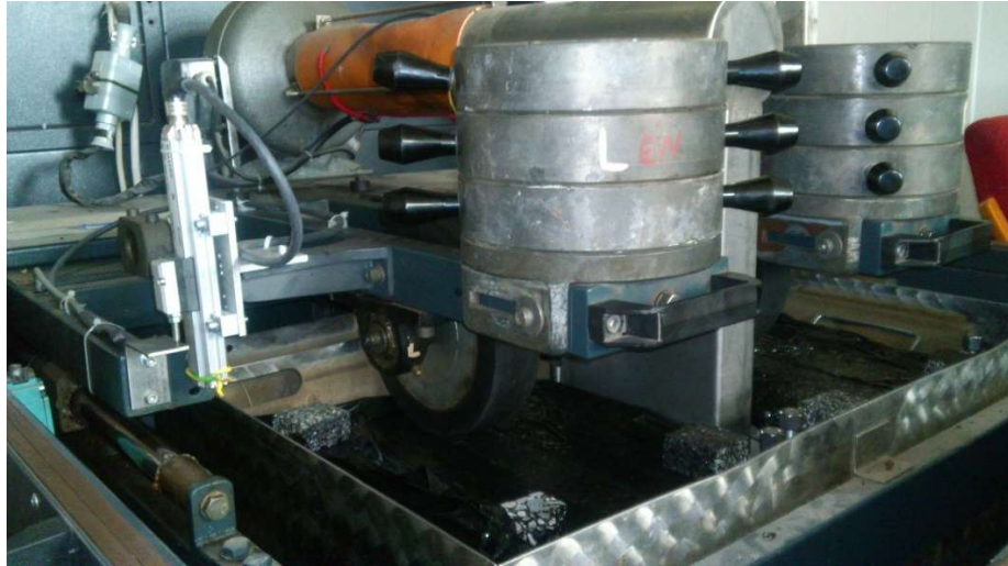
Obr. 21: Zařízení pro zkoušku pojíždění kolem
