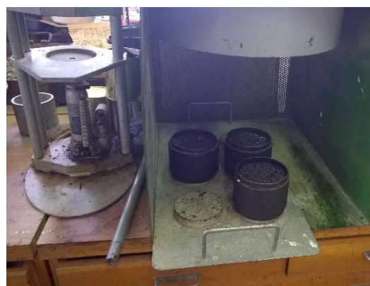
Obr. 11 Chlazení těles a výtlačné zařízení
