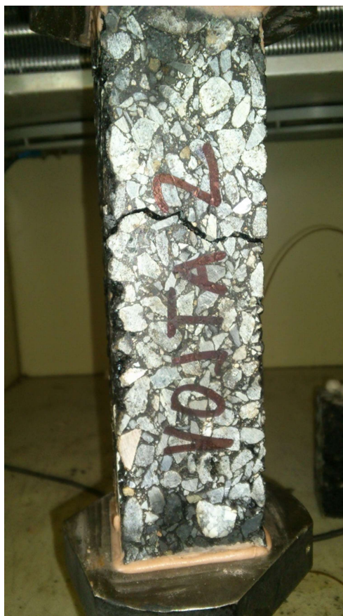
Obr. 24: Porušený vzorek po zkoušce nízkoteplotních vlastností
