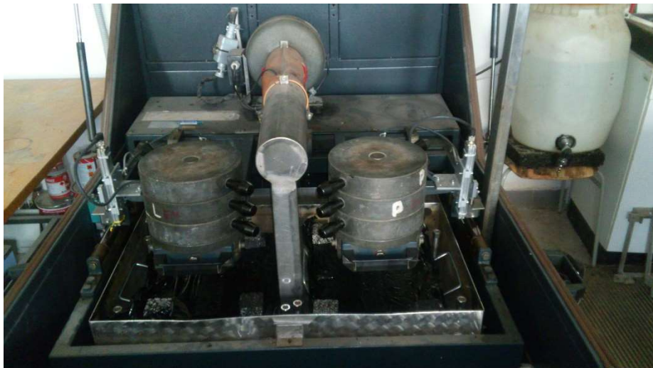
Obr. 22: Obě desky v zařízení pro pojezd kolem
