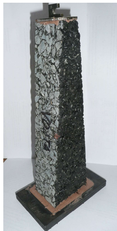
Obr. 25: Zkušební těleso pro stanovení modulu tuhosti
