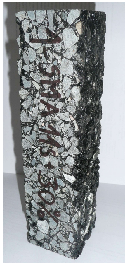
Obr. 15: Zkušební těleso pro stanovení nízkoteplotních vlastností
