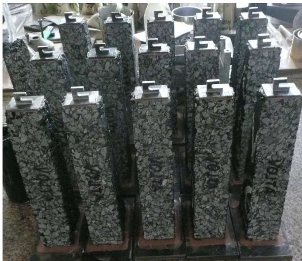
Obr. 19: Sada zkušebních těles pro stanovení modulů tuhosti
