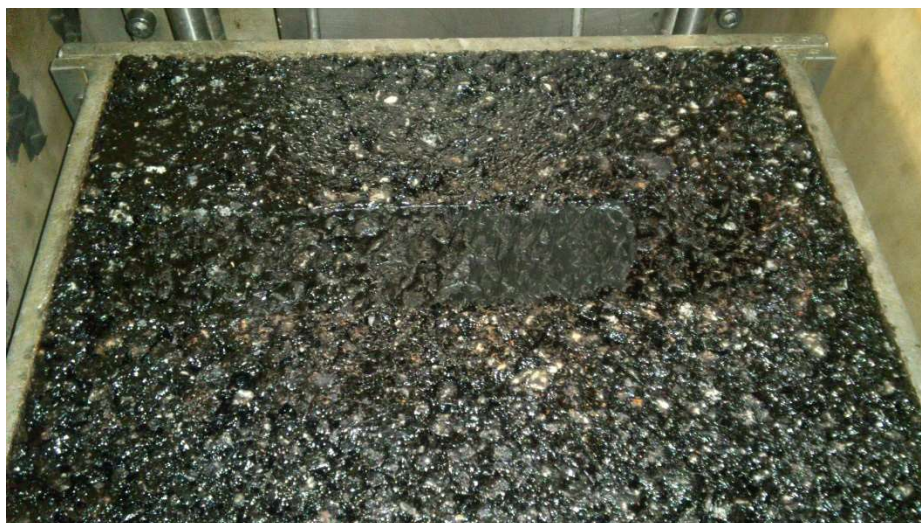
Obr. 23: Deska po zkoušce pojíždění kolem
