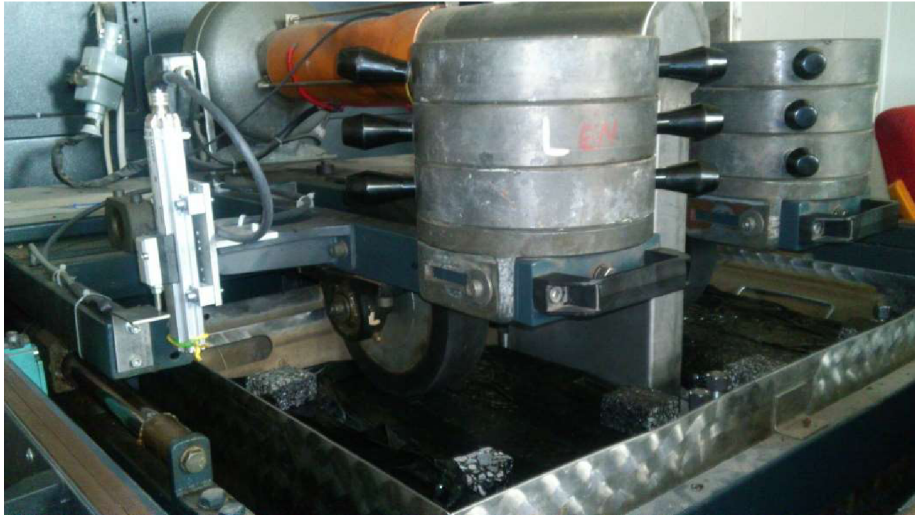
Obr. 21: Zařízení pro zkoušku poježdění kolem
