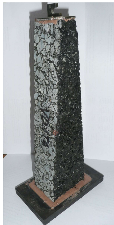
Obr. 25: Zkušební těleso pro stanovení modulu tuhosti
