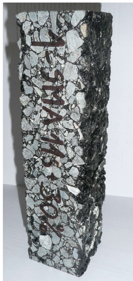
Obr. 15: Zkušební těleso pro stanovení nízkoteplotních vlastností
