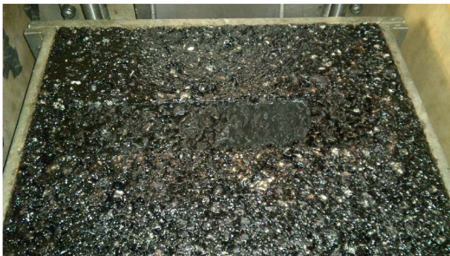
Obr. 23: Deska po zkoušce poježdění kolem
