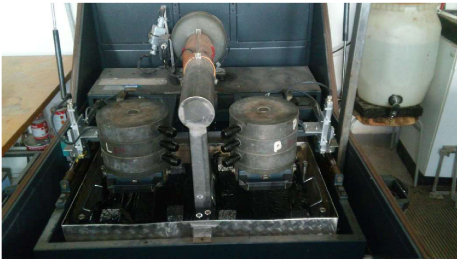
Obr. 22: Obě desky v zařízení pro pojezd kolem
