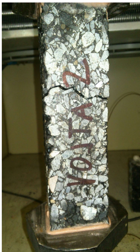
Obr. 24: Porušený vzorek po zkoušce nízkoteplotních vlastností
