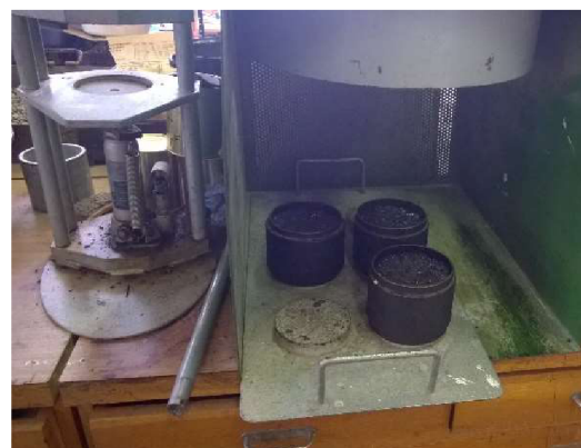
Obr. 11 Chlazení těles a výtlačné zařízení
