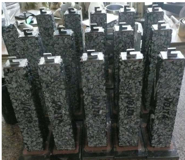
Obr. 19: Sada zkušebních těles pro stanovení modulů tuhosti
