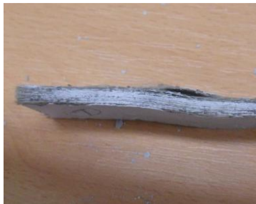
Obr. 57 Delaminace vlákněné výztuže po ohybové zkoušce
