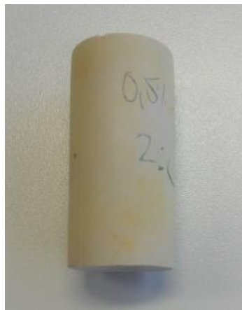
Obr. 65 Geopolymer s 0,5% čedičových vláken bez úpravy při pokojové teplotě
