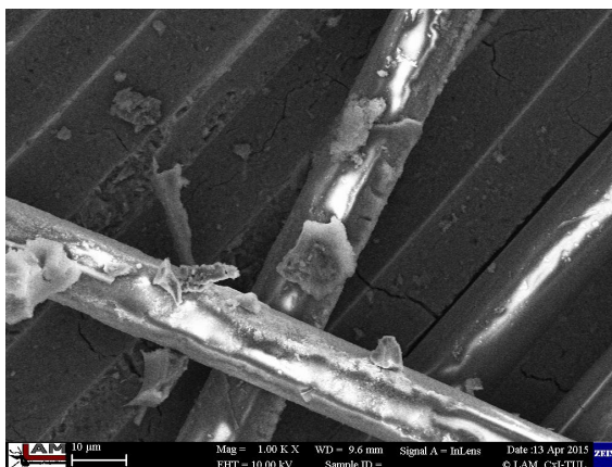
Obr. 62 Geopolymer se skleněnými vlákny očištěnými v acetonu a plazmově modifikovanými v plátnové vazbě
