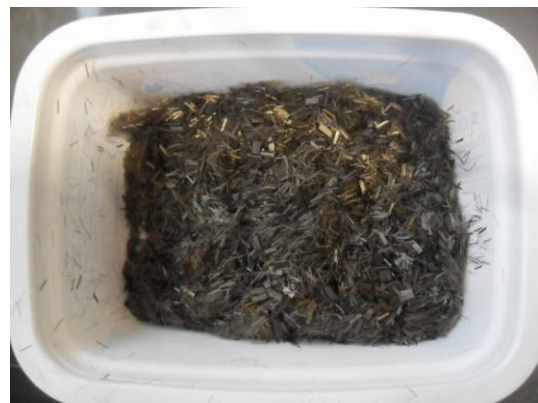
Obr. 30 Krátká čedičová vlákna
