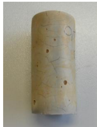
Obr. 67 Geopolymer s 0,5% čedičových vláken bez úpravy po ohřátí na 500°C
