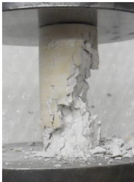
Obr. 69 Porušení vzorku po tepelné zátěži 250°C
