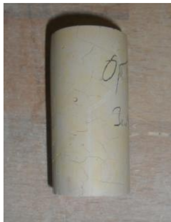
Obr. 66 Geopolymer s 0,5% čedičových vláken bez úpravy po ohřátí na 250°C
