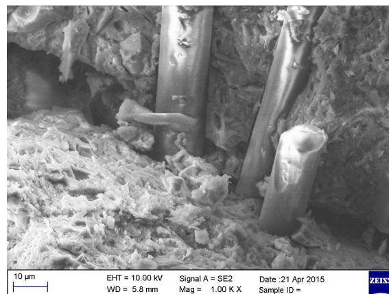
Obr. 74 Geopolymer s čedičovými vlákny očištěnými acetonem, 250°C, 5 % vláken, po tlakové zkoušce
