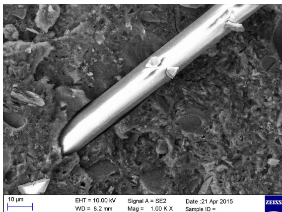
Obr. 70 Geopolymer s čedičovými vlákny očištěnými acetonem, bez ohřevu, 3 % vláken, po tlakové zkoušce
