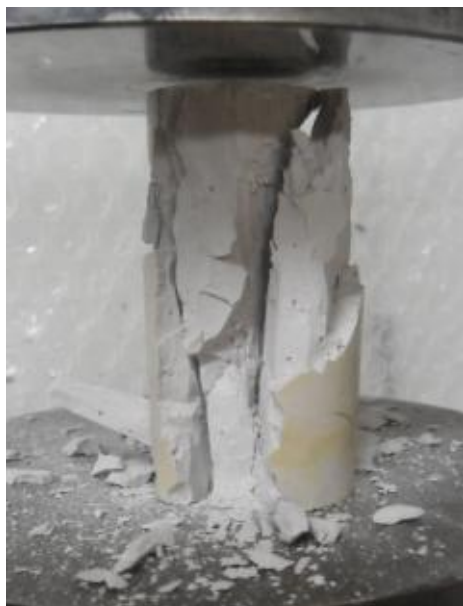
Obr. 68 Porušení vzorku bez ohřevu po zkoušce tlakem
