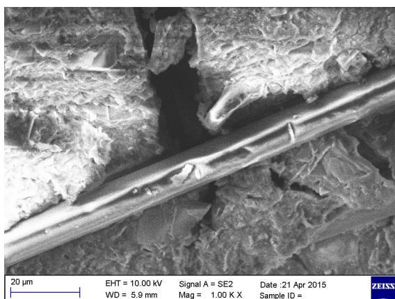
Obr. 75 Geopolymer s čedičovými vlákny očištěnými acetonem, 500°C, 5 % vláken, po tlakové zkoušce
